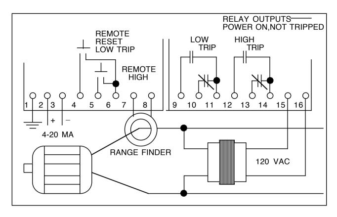
\* VOLTAGE TRANSFORMER NOT REQUIRED FOR 120V MOTORS
